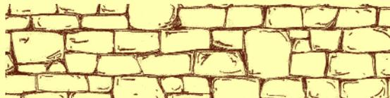
› **les appareils irréguliers**, en pierres peu retailées de différents calibres. Ce type d'appareil est courant dans le Saint-Lois où les pierres présentent un aspect allongé et éclaté.
